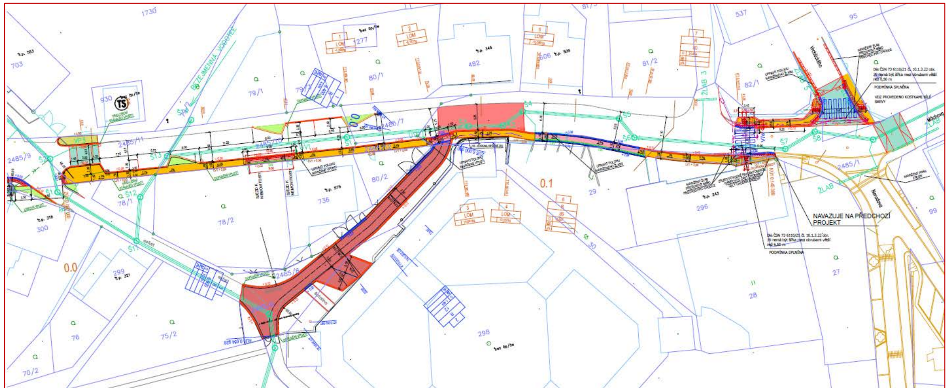
Obrázek 9 Vybudování a rekonstrukce chodníků v ulici Žižkova, Česká Kamenice – úsek 1 – nový stav
